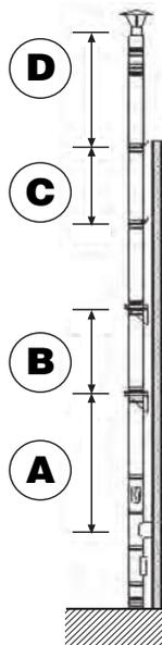
A: massima altezza raggiungibile utilizzando l'elemento a T 90 con elemento base una piastra base
