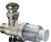
AT0100728CG                | Filtro defangatore magnetico COMPACT-GAUSS<br>- Corpo: ottone nichelato - Vaso: tecnopolimero trasparente - Rete filtrante: AISI 316<br>- Valvola a sfera: integrata con leva in alluminio verniciato - Raccordo girevole: ottone nichelato - O-ring: silicone/NBR - Magnete: NdFeb 12800 Gauss<br>- Grado di filtrazione: 800 micron.<br>Accessori opzionali: | 1          | 65,49  |
